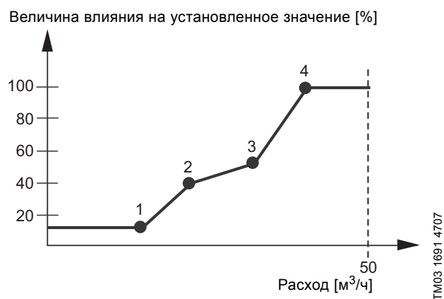
Рис. 46 Соотношение между влиянием на установленное значение и расходом
